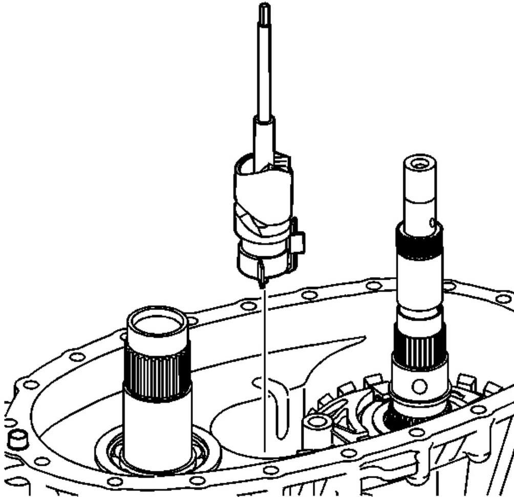
**Fig. 87: Shift Detent Lever Assembly**
